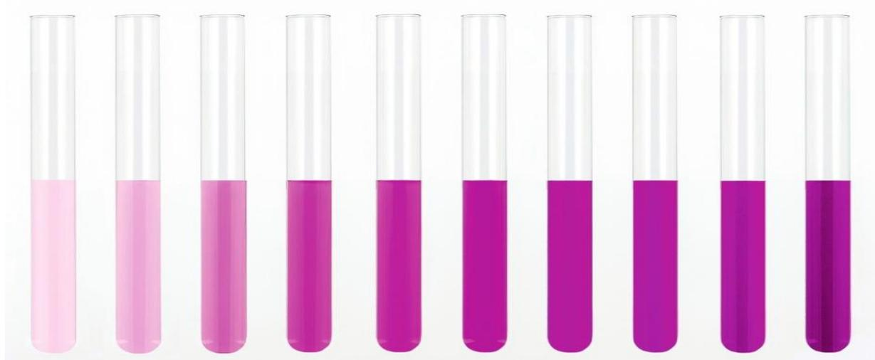
**Figure 2.3**—Exemple de gamme étalon pour une solution de permanganate de potassium (*source*).
